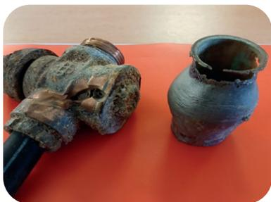
Le deuxième est un raccord en plomb qui, sous la pression de l'eau, a été littéralement ouvert en deux, cela provoquant une perte d'eau de plusieurs centaines de mètres cubes par jour.
